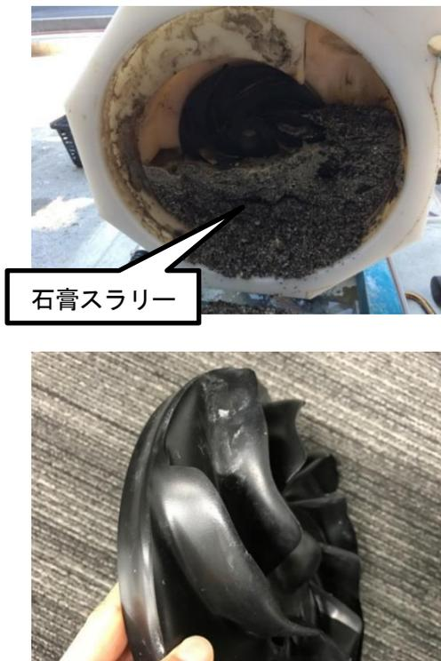
図 17 PVDF インペラ運転時の内部と摩耗状況
