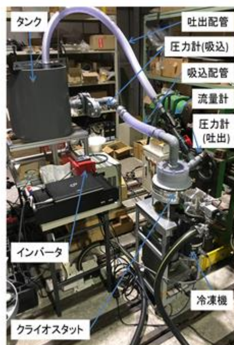
図 13 超伝導浮上ポンプ運転状況
