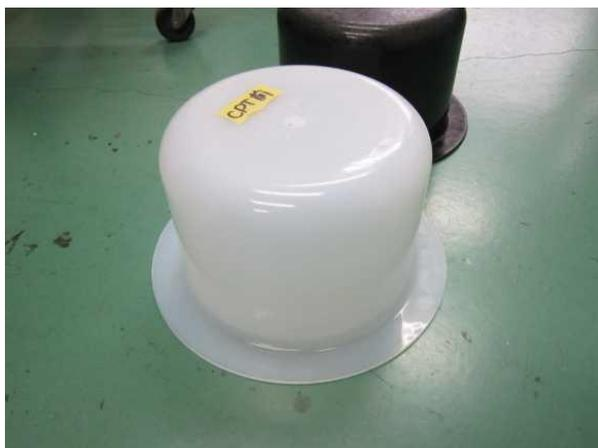
図6 低透過弗素樹脂リアケーシング成形品
