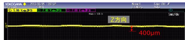
図7 5000min<sup>-1</sup>運転時の回転子のスラスト方向の変位
