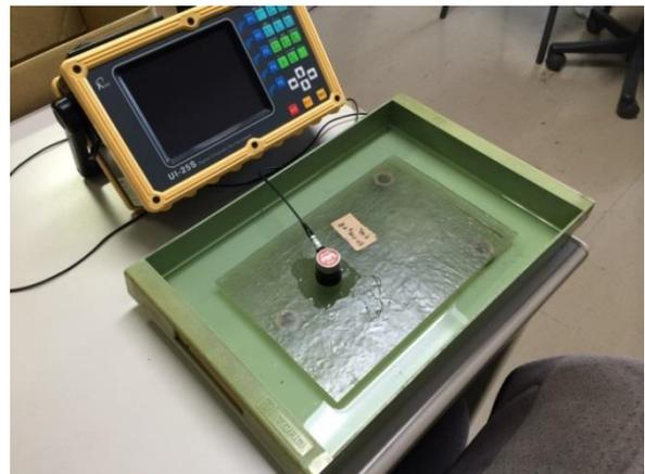
図4 ブランク材のエコー測定
