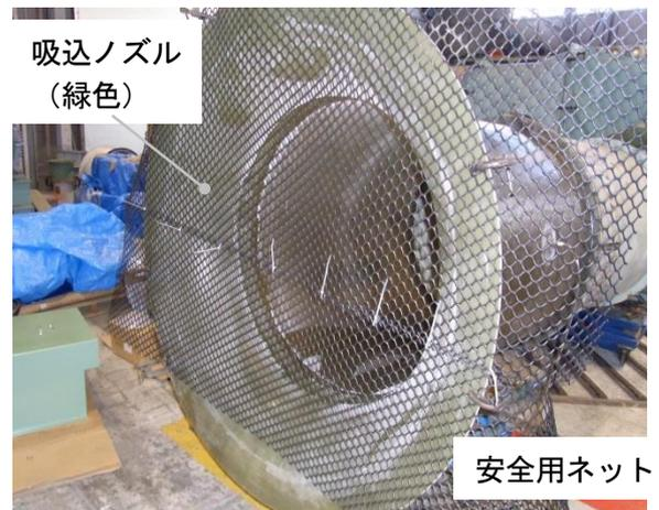
(a) 吸込側: 吸込ノズル (FRP 製)
