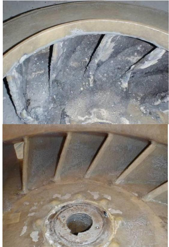
図 1 羽根車の洗浄前(上)、洗浄後(下)
