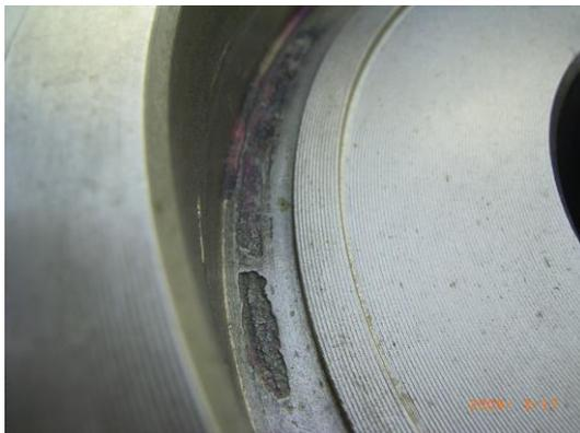
図-10 隙間腐食事例
