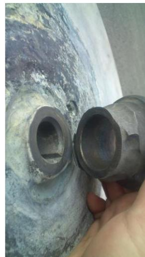
図-8 乾燥塩素による腐食事例 (羽根車)
