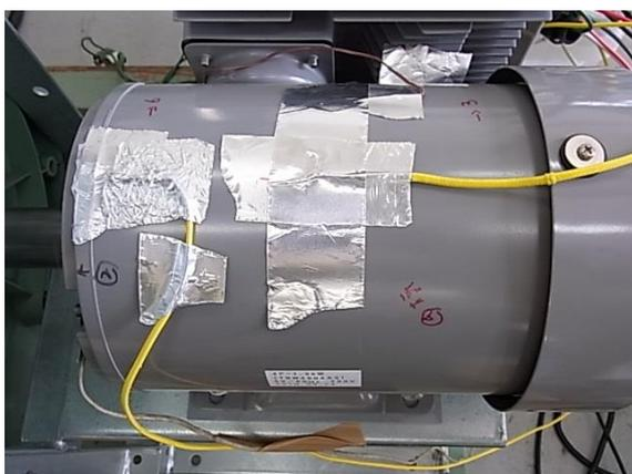
図-4 モータ温度試験風景
