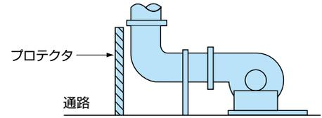
5) 送風機の配管・据付けは、下図のように取付けて下さい。
