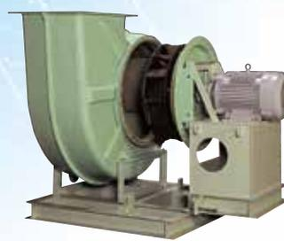
FTF503～803は吸込み・吐出シダクトを取り付けたまま、羽根車を電動機と一体で取り外すことが出来るバックプルアウト方式を採用。部品交換やメンテナンス作業が素早く・容易に行え、従来どおり、吸込み側からの羽根車の取外しも可能です。
