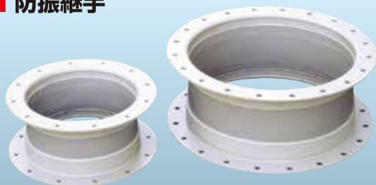
送風機とダクトの間に接続し、送風機振動のダクトへの伝搬を少なくすると共に、ダクトの荷重を送風機にかけないようにするために使用するものです。送風機の配管時には必ずご使用下さい。
