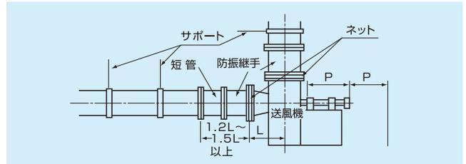
6) ダクト配管は下図の配管例の実線のように、風がスムーズに流れるように設計して下さい。特に送風機の吸込側で下図の破線の配管は、振動や騒音を増加させるばかりか、性能低下も招くことがありますのでご注意下さい。
