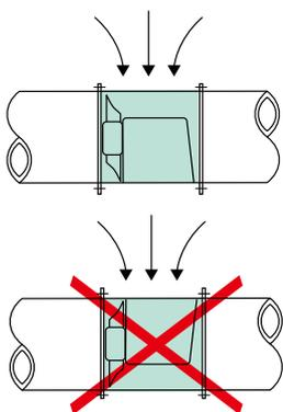
2 電動機の開放部を壁側に向けて設置して下さい。
