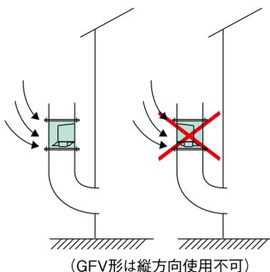
3 雰囲気の悪いピットの場合は、外に設置して下さい。また、急縮小となる吸込口にはベルマスの取付をお勧めします。
