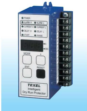
テクセル・インテリジェント・ドライ・ラン・プロテクター〈DRP〉は、ポンプ運転電流値を電動機電流で連続的に検出し、ポンプで発生する空運転や揚水(液)不能運転、締切運転などの異常運転、キャビテーションなどの過度現象および過負荷運転からポンプを保護するため自動的にポンプを停止させ、同時に警報を発することのできる装置です。
